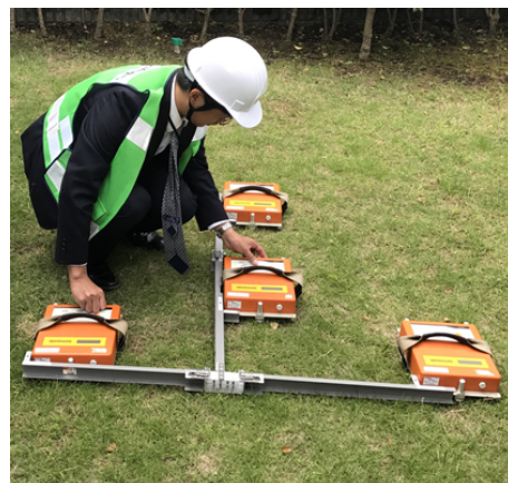
微動探査システムにて地盤の揺れを見える化
